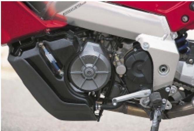
Aprilia 60-Grad-V2 erhielt für den Einsatz in der Caponord neue Nockenwellen, Drosselklappen, Einspritzdüsen, Kolben sowie modifizierte Brennkammern.
