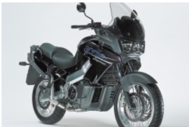
*Das kantige Design ist im Windkanal entwickelt worden und zeichnet sich durch gute Aerodynamik sowie tollen Wind- und Wetterschutz für die Besatzung aus.*
