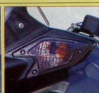
Les clignotants intégrés au carénage sont équipés de lampes blanches sous cache orange.
