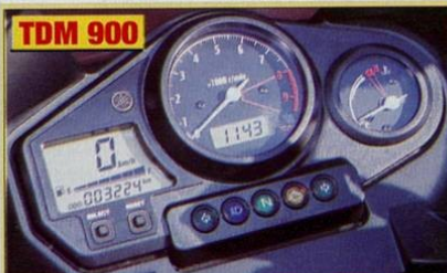
TDM 900 Le tableau de bord TDM est on ne peut plus sobre. Complet et lisible, il comporte deux trips partiels, une jauge précise, une horloge et la batterie de voyants habituels.
