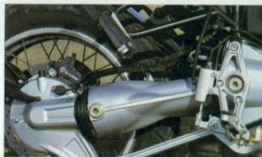
La BMW dispose elle aussi d'une molette de réglage rapide de la suspension arrière. Elle possède aussi un réglage en hydraulique de la suspension arrière et un réglage de précontrainte de l'amortisseur avant.
