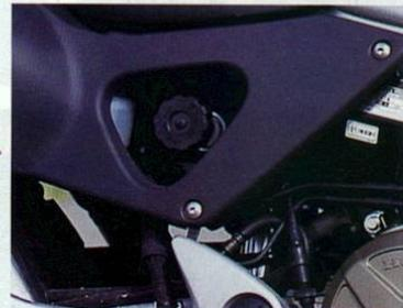
La Varadero dispose aussi d'une molette de réglage de la précontrainte facilement accessible. C'est d'ailleurs le seul élément à régler sur la partie cycle. Ce qui évite aussi de se tromper.
